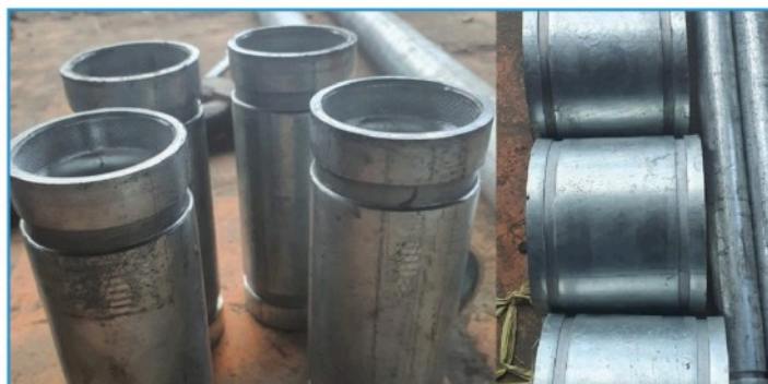
GIA CÔNG ống CÁN TẠO Rãnh MACHINING OF GROOVED ROLLED TUBES
